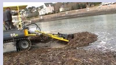
L'objectif est d'utiliser cet engin pour rejeter les algues dans le chenal au fur et à mesure qu'elles se déposent, notamment à chaque grande marée, les jours de fort coefficient. Ce véhicule amphibie sera par ailleurs suffisamment polyvalent pour être utilisé au nettoyage du port à flot et même intervenir sur le banc de sable à l'entrée du port.
