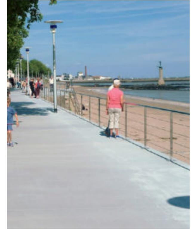
Mur arasé et remplacé par un garde corps métallique à permis une promenade plus confortable en front de mer.
